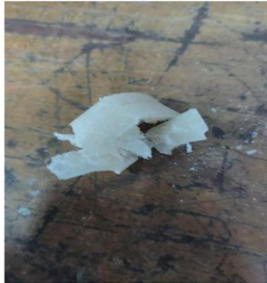
**Gambar 3.4** Spesimen Uji Tekan Setelah Pengujian
