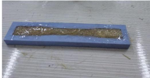
**Gambar 2. 1** Cetakan Spesimen Uji Tarik
