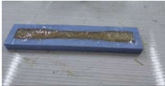
Gambar 2. 1 Cetakan Spesimen Uji Tarik
