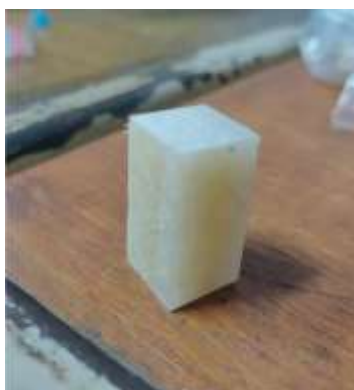
Gambar 2. 3 Spesimen Uji Tekan Sebelum dan Sesudah Uji
