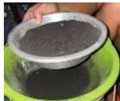
Gambar 4. Proses Penyaringan Arang
