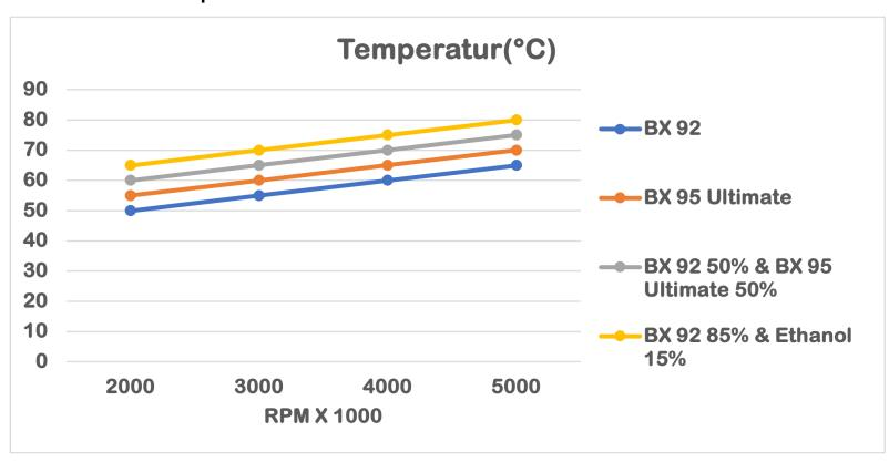
Kesimpulan pada pengujian temperatur pada RPM 2000 - 5000 dengan penggunaan bahan bakar BX 92, BX 95 Ultimate, Campuran BX 92 50% & BX 95 Ultimate 50%, dan Campuran BX 92 85% & Ethanol 15% adalah didapati nilai tertinggi 80 pada RPM 5000 dengan penggunan bahan bakar campuran BX 92 85% & Ethanol 15% dan nilai terendah 50 pada RPM 2000 dengan penggunaan bahan bakar BX 92.
