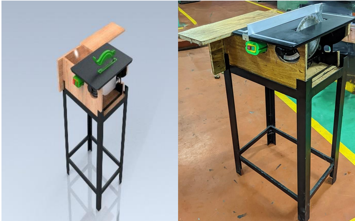
Gambar 3. Gambar desain dan foto hasil manufaktur
