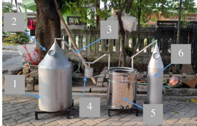
Gambar 3. Hasil Pembuatan prototype alat produksi asap cair
