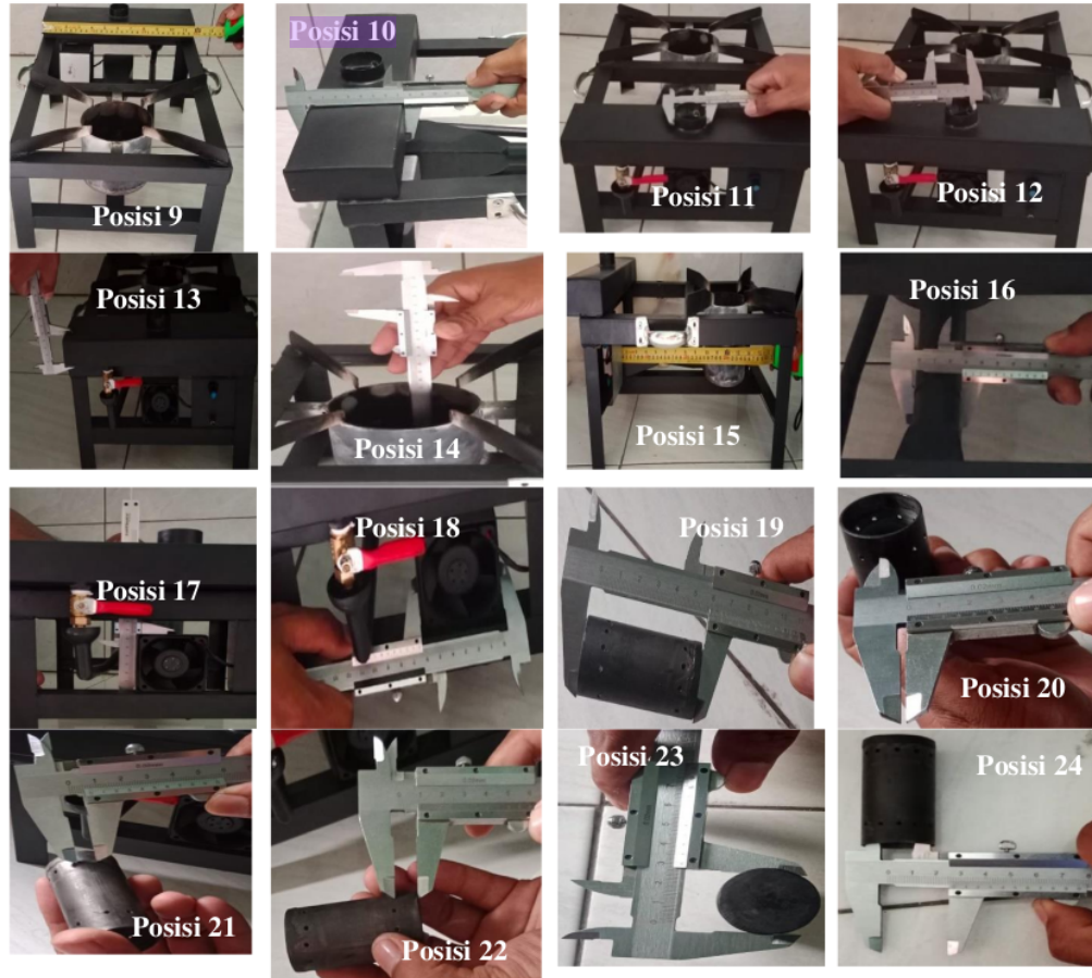
Gambar 3 Pengukuran Secara Visual Dengan Jangka Sorong Dan Meteran Gulung.
