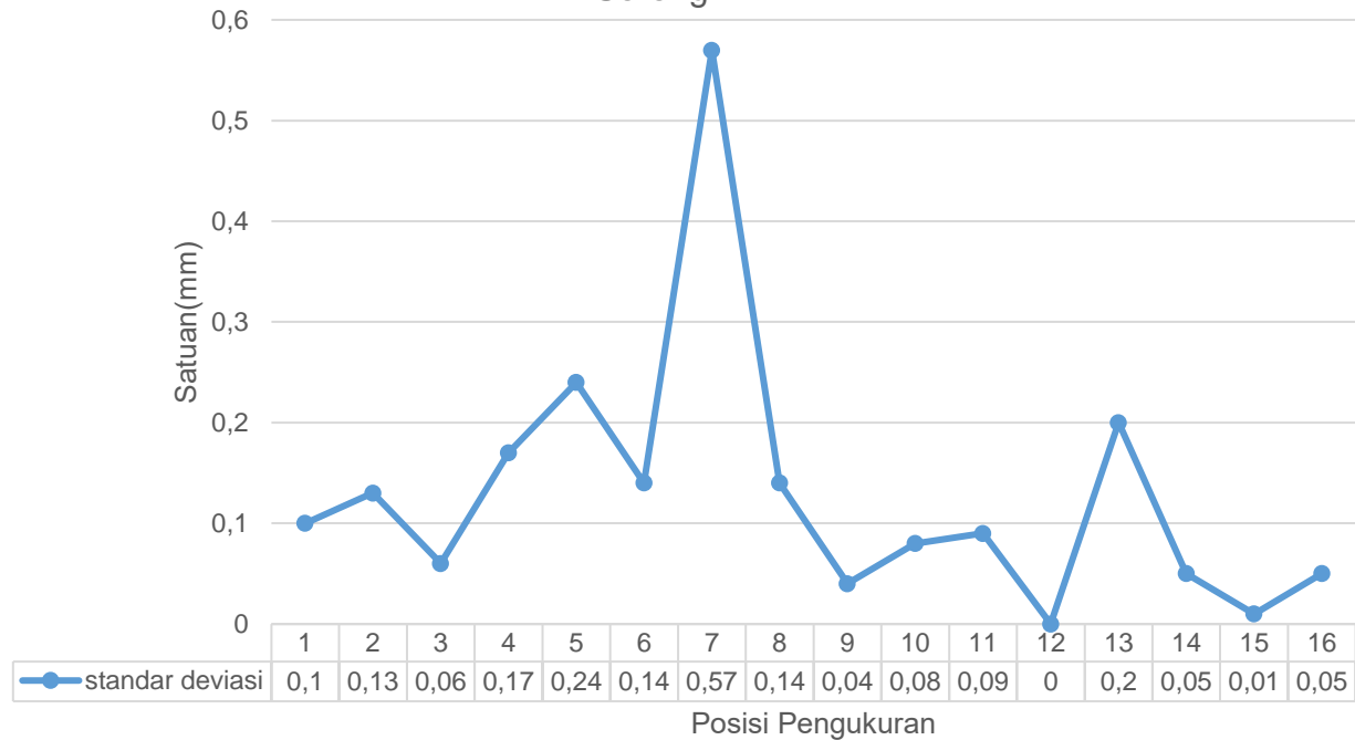
Hasil Perhitungan Standar Deviasi Pengukuran dengan Jangka Sorong
