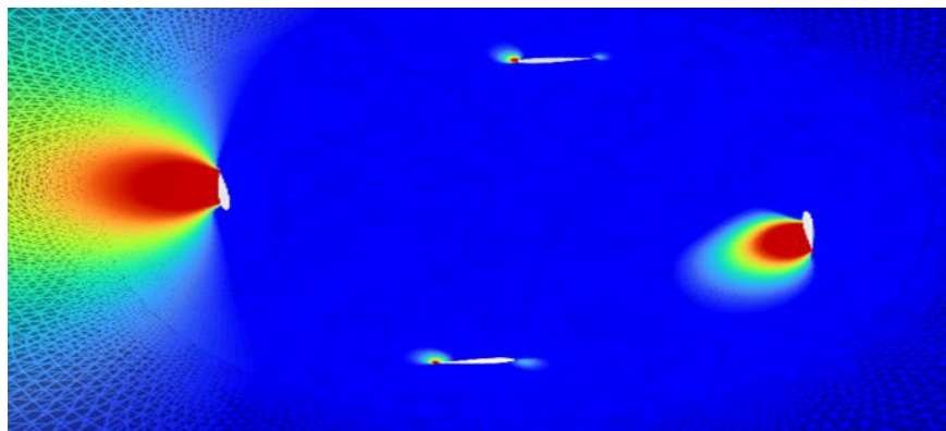
Gambar 6. Persebaran tekanan fluida pada rotor sudut -5^\circ
