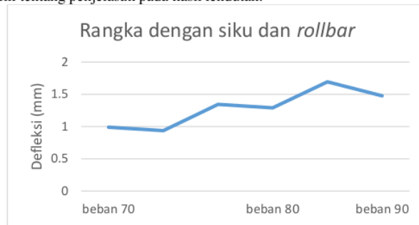
Gambar 8. Grafik rangka dengan siku dan rollbar
