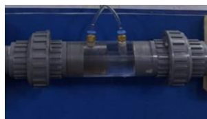
Gambar 7. Uji spesimen yang dialiri air
