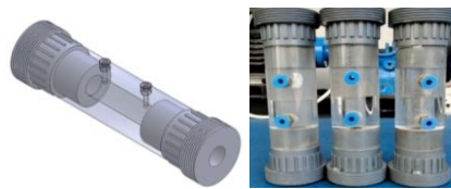
Gambar 1. Desain Tabung Akrilik dan Hasil Pembuatan
