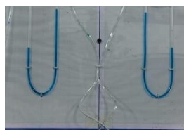
Gambar 8. Uji manometer U pada milimeterblok
