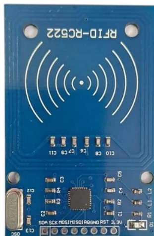
Gambar 5. Tampilan Sensor RFID yang Terpasang Pada Alat
