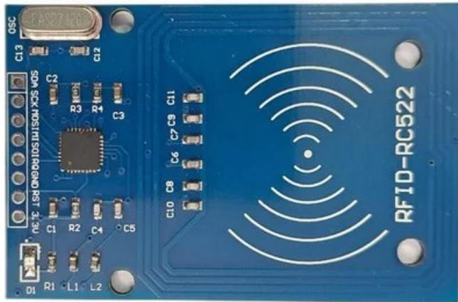
Sensor RFID dapat mendeteksi tag RFID dengan rentang jarak antara **0,5 cm hingga 5 cm** dengan jenis penghalang kertas dan plastik, sehingga sensor RFID dapat **menggerakkan selenoid** yang akan membuka loker. Selain itu, sensor RFID **tidak akan terbaca maupun terdeteksi** apabila jarak tag RFID lebih dari **5 cm**. Sensor RFID juga tidak dapat membaca tag RFID apabila terhalang oleh logam.
