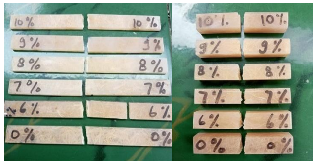
Gambar 2 Spesimen Setelah Di Uji Tekuk / Bending dan Uji Impact
