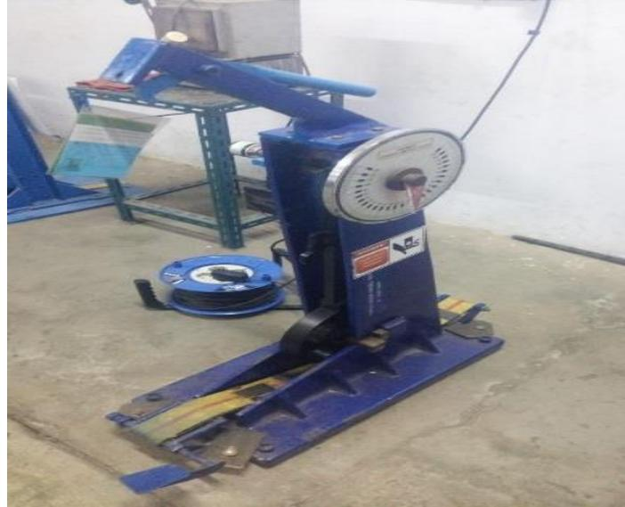
pengujian *impact* yaitu material yang di hantam secara tiba tiba karena penyerapan energi yang berpengaruh pada saat pembebanan pada saat dihantam spesimen. Penyerapan tenaga ini dirubah pada material yaitu perubahan bentuk deformasi plastis.
