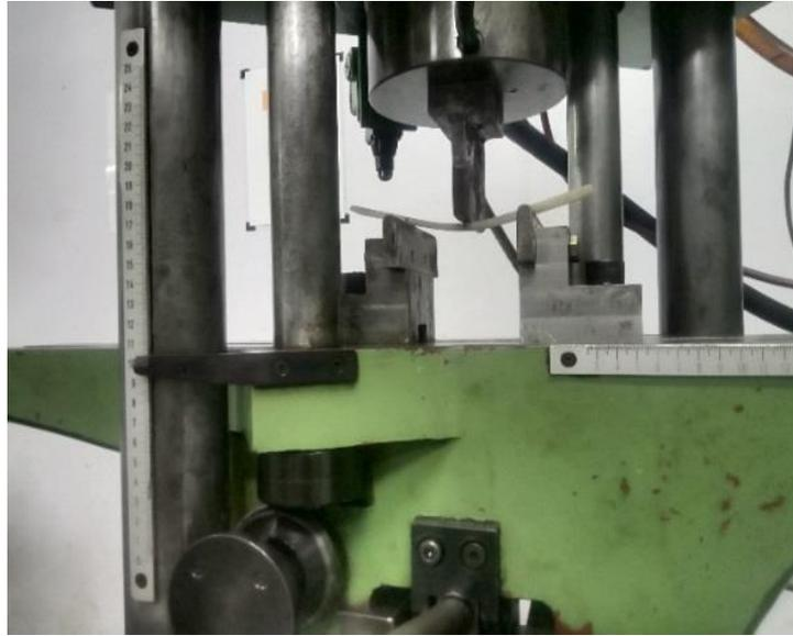
Uji bending atau tekuk adalah pengujian untuk mengukur kekuatan material akibat pembebanan dan elastisitas sampel. Suatu metode untuk menguji material dengan cara menekannya untuk mengukur kekuatan lengkungnya (bending). Bending tiga poin menggunakan dua poin di bagian bawah sebagai tumpuan dan satu poin di bagian atas sebagai penekan
