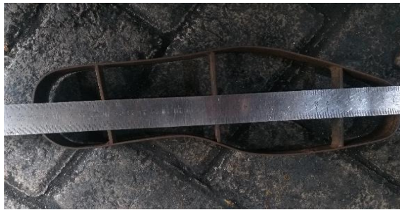
Gambar 2.5 Proses pengukuran pisau plong out sol sepatu
