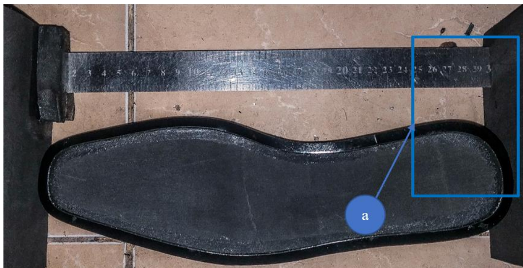
Gambar 3.5 Pengukuran cacat out sol sepatu.
