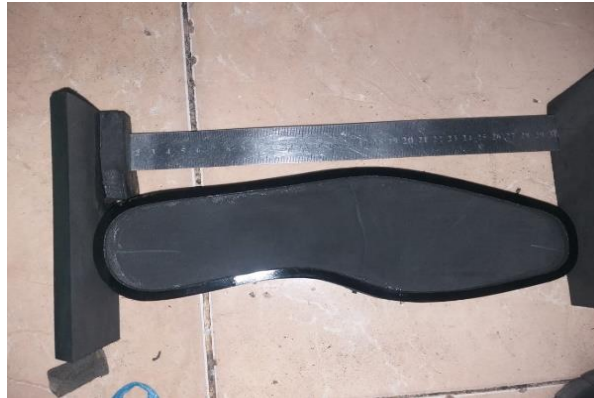
Gambar 2.4 Proses pengukuran out sol sepatu
