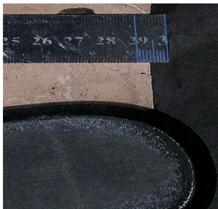
Gambar 3.6 (a) Hasil pengukuran Gambar 3.5 cacat out sol sepatu berukuran 29,9.
