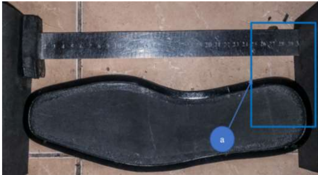
Gambar 3.5 Pengukuran cacat out sol sepatu.
