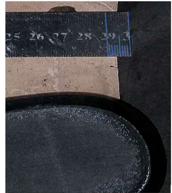
Gambar 3.6 (a) Hasil pengukuran Gambar 3.5 cacat out sol sepatu berukuran 29,9.
