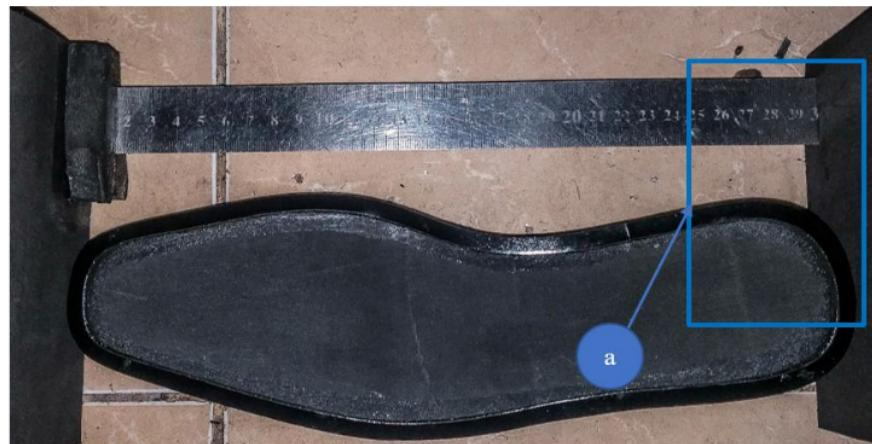
Gambar 3.5 Pengukuran cacaat *out* sol sepatu.
