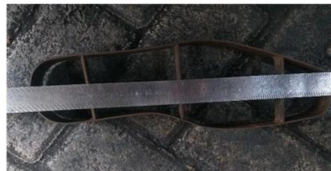
**Gambar 2.5** Proses pengukuran pisau plong out sol sepatu
