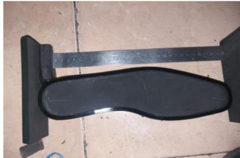
**Gambar 2.4** Proses pengukuran out sol sepatu
