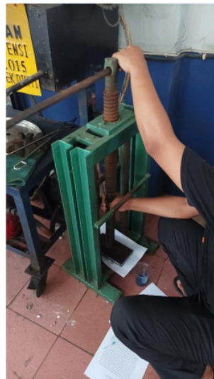
Gambar 2. Metode press yang digunakan saat membuat material komposit
