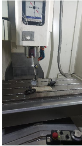
Gambar 10. Pengujian kerataan permukaan menggunakan alat dial indikator
