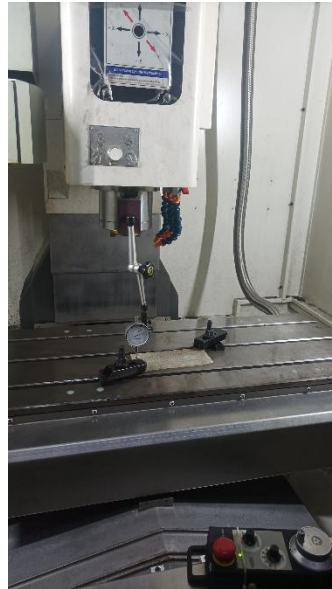
Gambar 10. Pengujian kerataan permukaan menggunakan alat dial indikator
