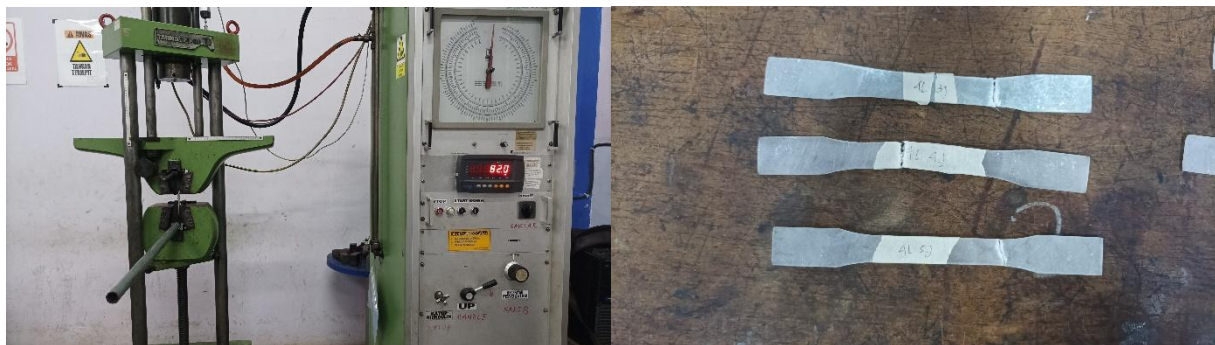
Gambar 8. Hasil Spesimen uji kekuatan tarik setelah di lakukan Pengujian
