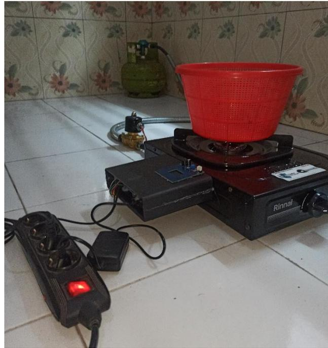
Pada Gambar di atas benda non logam diletakkan di atas permukaan kompor gas LPG yang menghasilkan kompor tidak menyala sama sekali dengan ini hasil yang diharapkan sesuai apa yang diinginkan peneliti.
