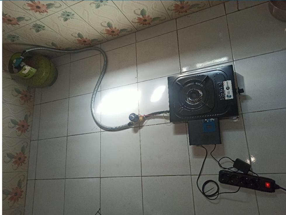
Pada Gambar di atas menunjukkan tampilan alat keseluruhan dengan beberapa komponen seperti metal detector, adaptor dan solenoid valve
