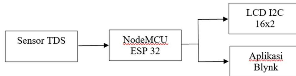
Penelitian ini menggunakan input yaitu adaptor 5V sebagai sumber daya utama dan sebuah sensor TDS sebagai input nilai arus dan tegangan yang datanya akan diterima dan diproses oleh mikrokontroler NodeMCU ESP32. Komponen output terdiri dari dua bagian yaitu LCD I2C 16x2 sebagai *display*, dan aplikasi Blynk sebagai perangkat monitoring kondisi arus dan tegangan serta pemberi notifikasi secara *real-time*.
