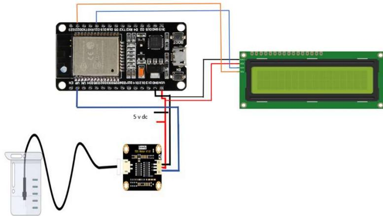
Pembacaan sensor tds sensor digunakan untuk mendeteksi kadar nilai konduktiviti yang terdapat pada air. Nilai yang didapat sensor diolah oleh mikrocontroller untuk dikirimkan pada smartphone. Pengiriman data oleh Node MCU ESP32 ke aplikasi Blynk. Aplikasi Blynk digunakan untuk penerima data pada smartphone.
