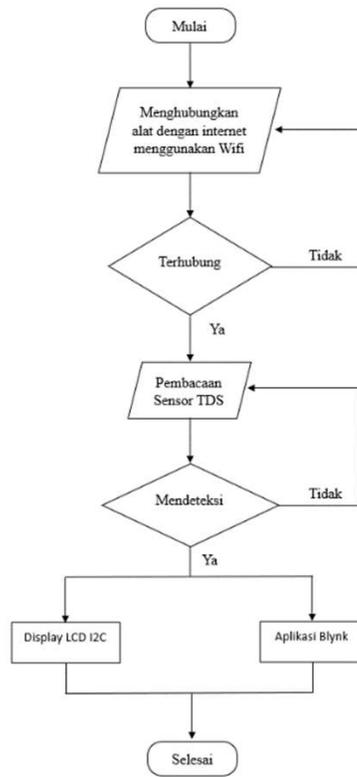
Proses Flowchart dimulai dengan menghubungkan NodeMCU ESP32 dengan internet melalui jaringan Wifi, kemudian proses berlanjut dengan pembacaan nilai konduktiviti (EC) pada air. Hasil dari pembacaan sensor akan dikirim dan ditampilkan pada LCD I2C dan aplikasi Blynk pada smartphone pengguna. Apabila nilai konduktiviti melebihi  $1 \mu\text{s}/\text{cm}$  akan muncul sebuah notifikasi pada aplikasi Blynk
