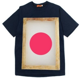
Kaos ditimpa dengan screen dan tinta sablon.
