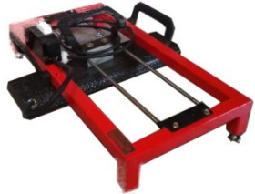
Curing untuk pengeringan tinta sablon yang menempel di kain.
