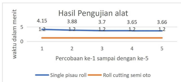
Gambar 2. Grafik Efisiensi Kinerja Roll Cutting Semi Otomatis.
