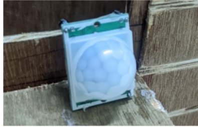
Gambar 5. Tampilan Sensor PIR yang Terpasang pada Alat
