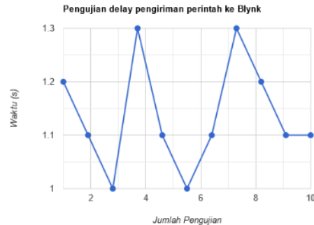
Gambar 6. Grafik Pengujian Delay Pengiriman
