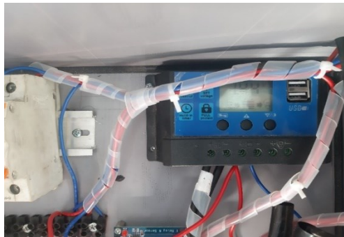
Gambar 4. Proses Pengujian Pengisian Solar Panel Saat Ditampilkan SCC
