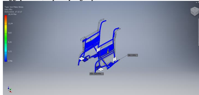
Gambar 9 Tegangan von mises pada body konsep A
