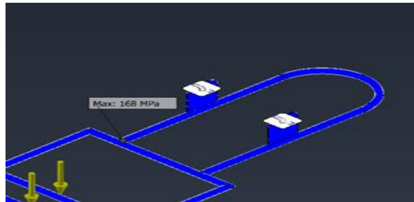
Gambar 13. Tegangan maksimal von mises pada chassis konsep B
