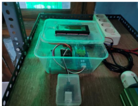
Gambar 5. Proses Pengujian Sensor DHT 22
