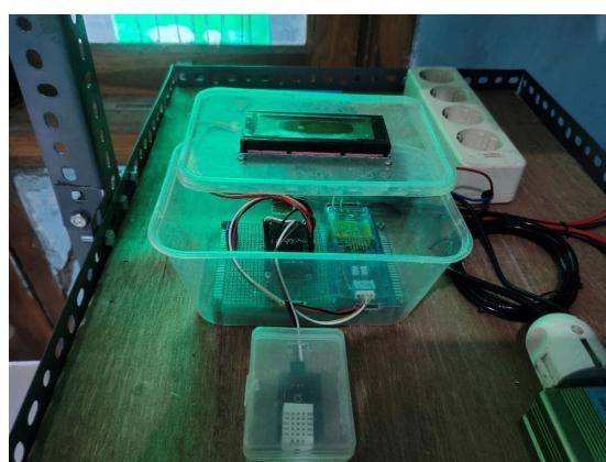
**Gambar 5.** Proses Pengujian Sensor DHT 22
