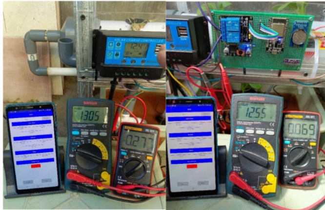
Gambar 5. Pengujian Pembacaan Sensor ADS1115 Untuk Mengukur Nilai Arus dan Tegangan Pada Solar Panel dan Baterai
