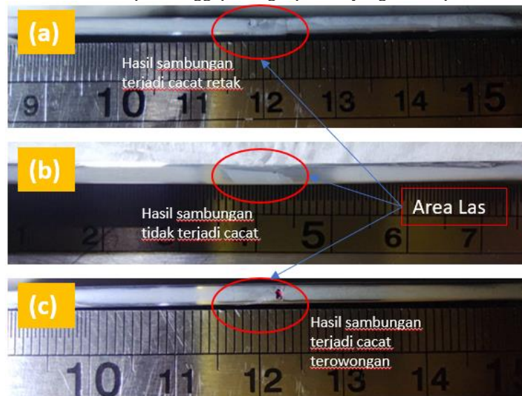
Gambar 6. Hasil uji makro spesimen 1, 2, dan 3 UFSW
