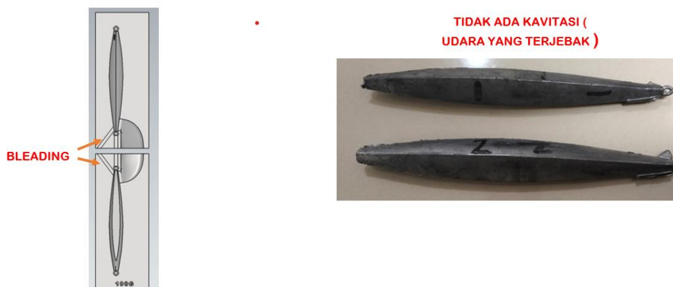
Gambar 4. Hasil Pengecoran sudut 90°
