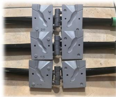
Gambar 2. Alat pencetak metal jig yang disempurnakan dengan metode sandblasting
