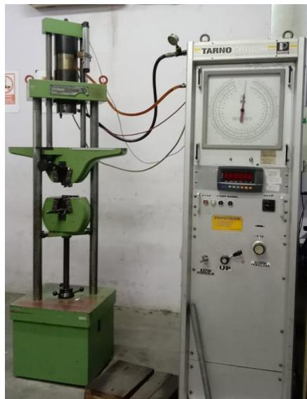
**Gambar 5.** Mesin uji tarik
