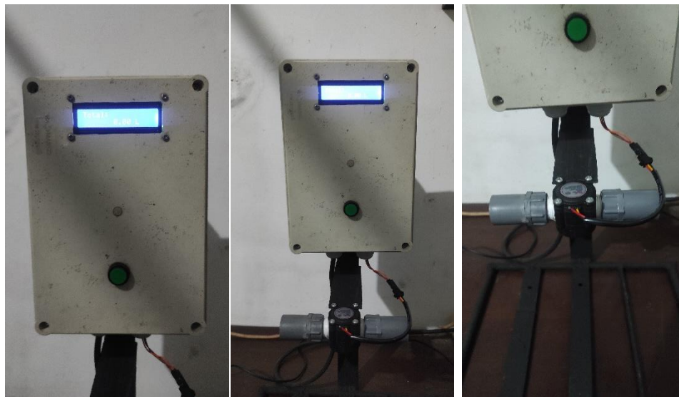
Gambar 4. Perangkat Pencatatan Debit Air Outlet Limbah IPAL
