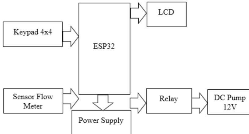
Gambar 5. Diagram blok pengendali keluar air
