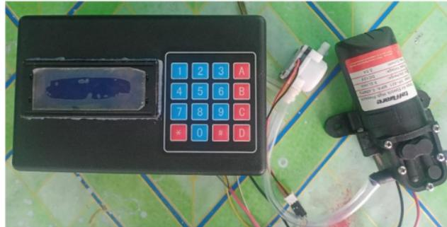
**Gambar 7.** Rangkaian perangkat keras pengendali air
