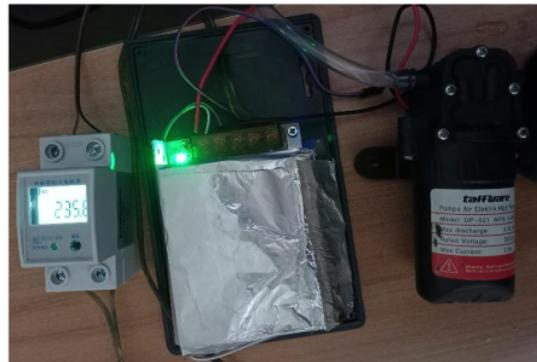
**Gambar 8.** Pengujian pompa air dengan wattmeter
