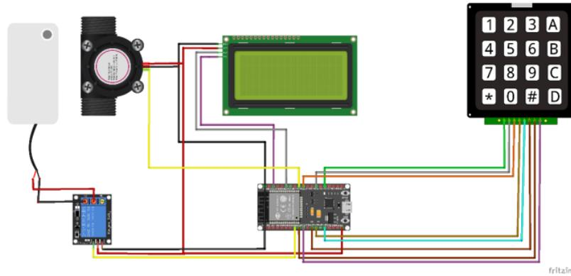
**Gambar 2.** Rangkaian skematik keseluruhan alat pengendali air
