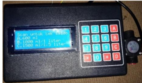
Gambar 10. Pengujian hasil pembacaan sensor water flow dengan tampilan LCD
