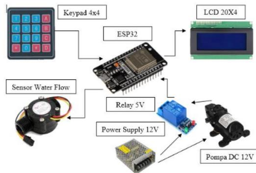
Gambar 4. Desain perancangan alat pengendali keluar air
