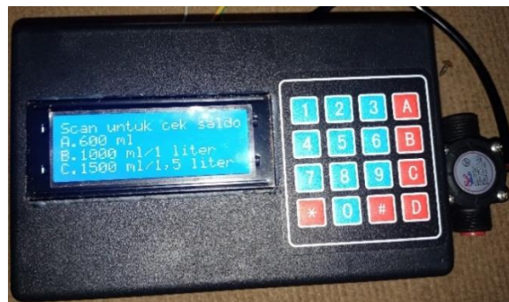
Gambar 10. Pengujian hasil pembacaan sensor water flow dengan tampilan LCD
