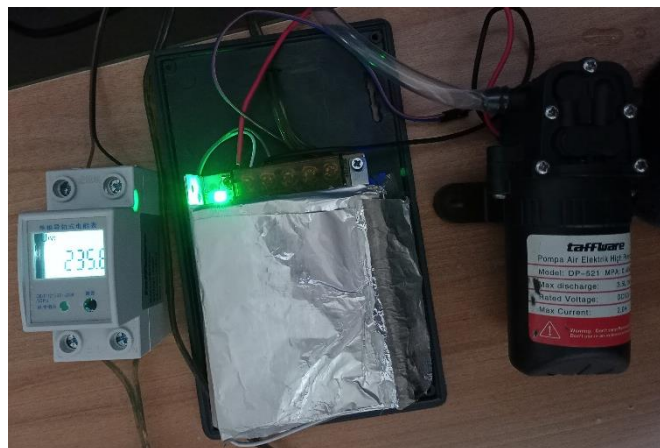
Gambar 8. Pengujian pompa air dengan wattmeter
