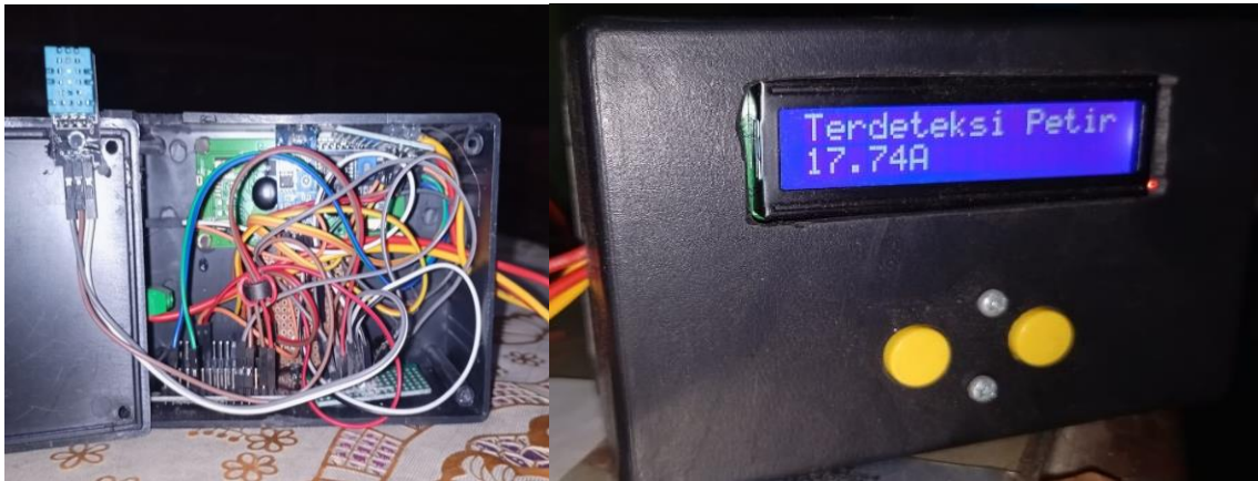
Gambar 4. Bentuk realisasi alat dengan komponen di bagian dalam box serta tampilan saat alat bekerja
