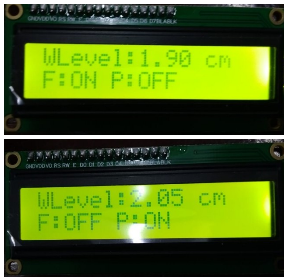
Gambar 5. Tampilan LCD I2C 16x2 saat Alat Bekerja
