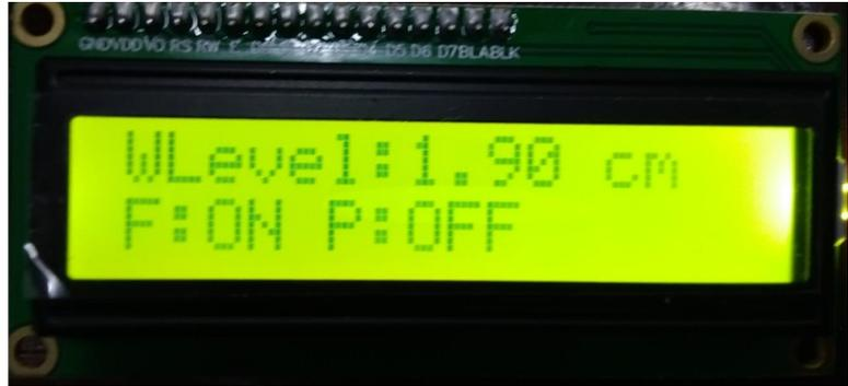
Pengujian LCD I2C untuk menampilkan data pembacaan sensor water level serta kondisi fan dan pompa berfungsi optimal seperti terlihat pada gambar di atas.
