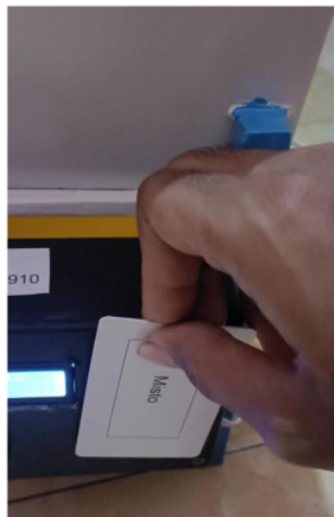
Gambar 8. Pengujian ID Card Dengan Sensor RFID-RC522
