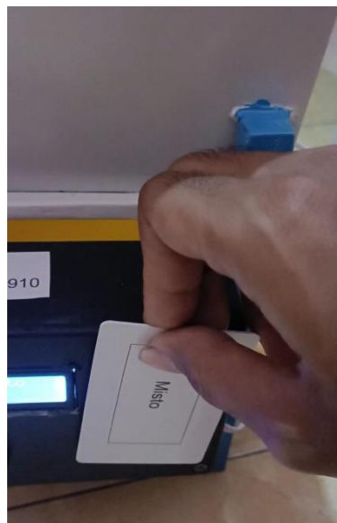
Gambar 8. Pengujian ID Card Dengan Sensor RFID-RC522
