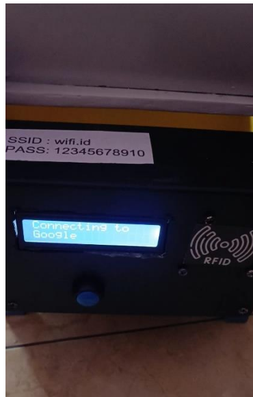
Gambar 6. Uji Koneksi Esp32 Dengan Koneksi Wi-Fi
