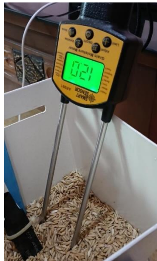
Gambar 9. Pengukuran Kadar Air Pada Sample
