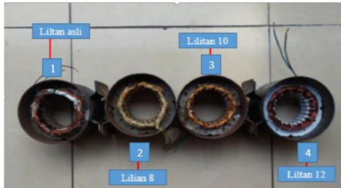
Gambar 2. Kutub Kumparan Pada stator setelah dimodifikasi
