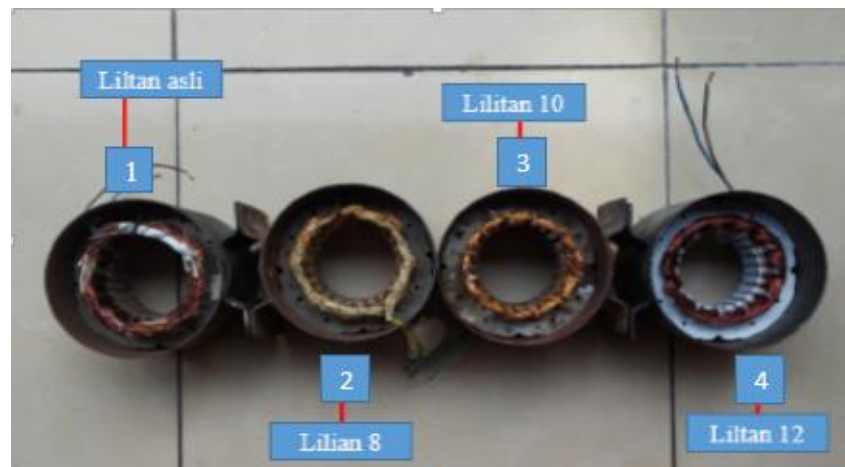
Gambar 2. Kutub Kumbaran Pada stator setelah dimodifikasi
