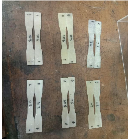
Gambar 5 Spesimen Benda Uji
