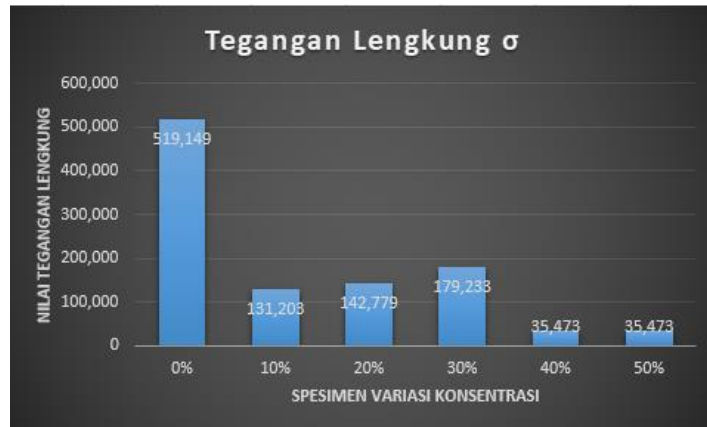
Gambar 9 Grafik Garis Tegangan Lengkung Uji Tekuk/Bending
