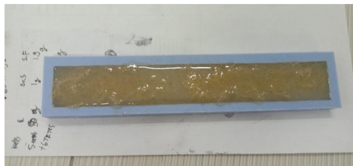
Gambar 4. Bahan dituangkan dalam cetakan
