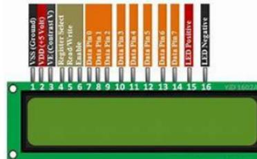
Gambar 4. Lcd 16 x 2
