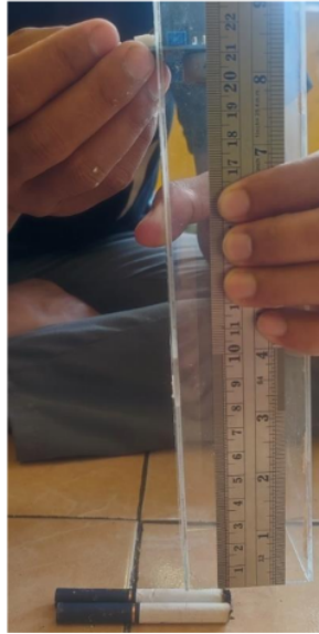
Gambar 5. Pengujian Sensor MQ-7 Dengan Jarak 20cm
