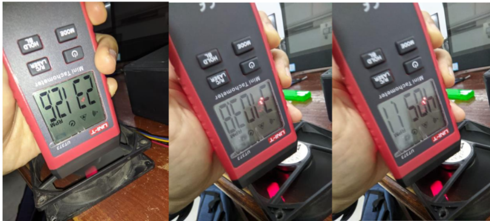
Gambar 10. Pengujian RPM fan dengan tegangan masukan 5V, 9V, dan 12V.
