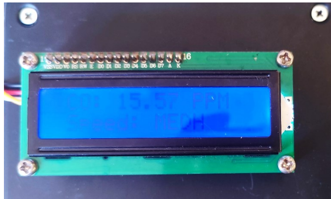
Gambar 8. Tampilan LCD I2C 16x2 saat nilai CO >11PPM dan <20PPM
