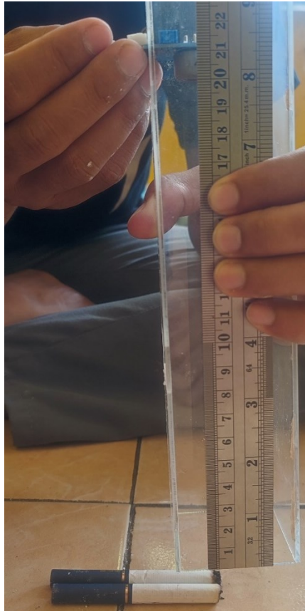
Gambar 5. Pengujian Sensor MQ-7 Dengan Jarak 20cm
