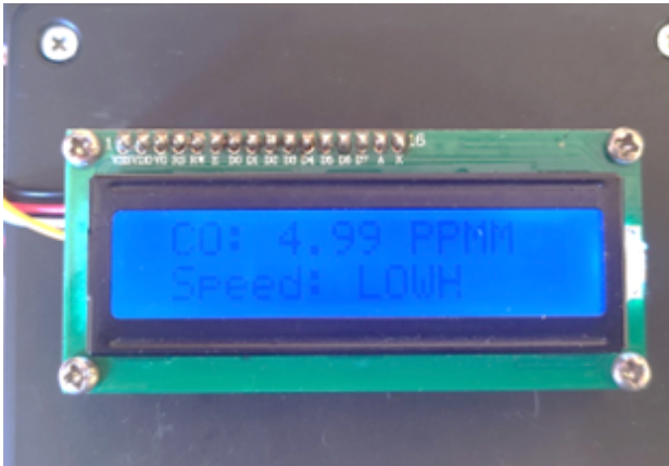
A. Tampilan LCD I2C 16x2 saat nilai CO <10PPM
