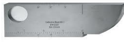
Gambar 5 Block Kalibrasi v1
